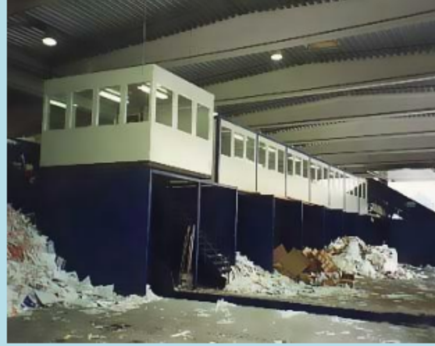
эстакада с конвейером и рабочими местами для сортировки отходов
