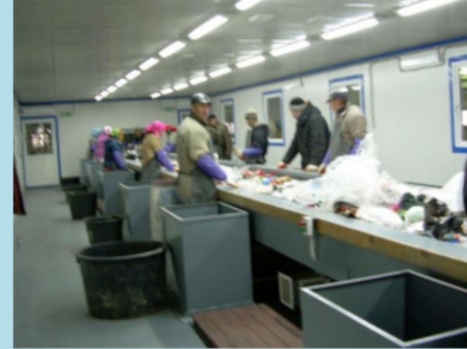
эстакада с конвейером и рабочими местами для сортировки отходов
