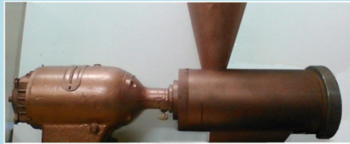
Дезинтегратор полимеров (более 200 кг/ч) в порошки от 50 мкм до 1 мм
